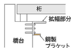
鋼製ブラケット設置工法
