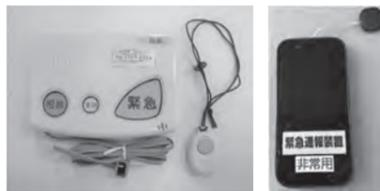
命の危険を伴うような急病や発作の懸念があり、緊急時に消防署への連絡が困難な人の自宅に、ボタンを押すだけで受信センターへ連絡できる機器を設置します。受信センターでは、利用者の状況によって、緊急の場合には消防署に通報し、緊急でない場合は家族等協力者へ連絡します。
