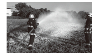
圧縮空気泡消火装置(CAFS:キャフス) ※水と消火薬剤を高圧の空気に混ぜて泡を作る装置
